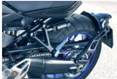
Il telaio principale che collega le parti è costituito da tubi d'acciaio e insieme agli altri elementi garantisce resistenza e flessibilità, mentre la forcella è rovesciata a doppio stelo esterna (cantilever). Sul posteriore, il forcellone è più lungo di 15 mm rispetto a quello della sorella a due ruote MT-09 e c'è
