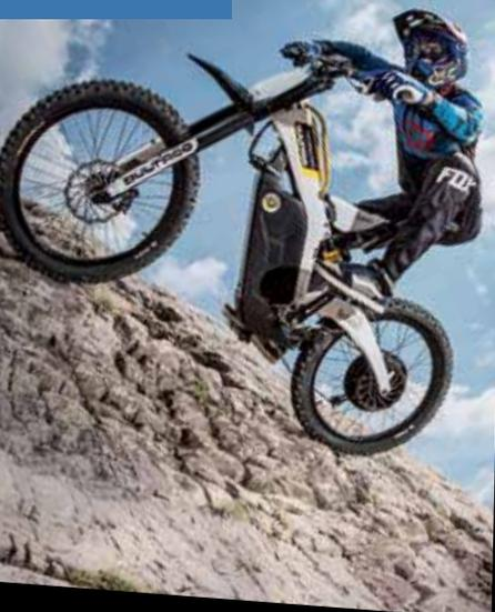
Bultaco Brinco — это микс кроссового мотоцикла и электрического велосипеда с усилением педального хода, который располагает электрическим мотором, встроенным в заднее колесо, способным выдавать 2 кВт мощности и 60 нм крутящего момента, в сочетании с переключением 9 скоростей (18 в овердрайве), который контролируется кнопкой, размещенной на стержнях-опорах педалей, он способен разогнать это средство передвижения до максимальной скорости в 60 км/ч.
