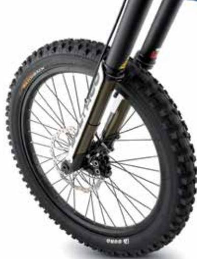
piggy back da 220 mm, pneumatici da 24 pollici adatti sia all'asfalto che al fuoristrada, e un sistema frenante composto da un disco anteriore flottante da 203 mm dotato di pinza a 4 pistoncini e da un disco da 203 al posteriore.
