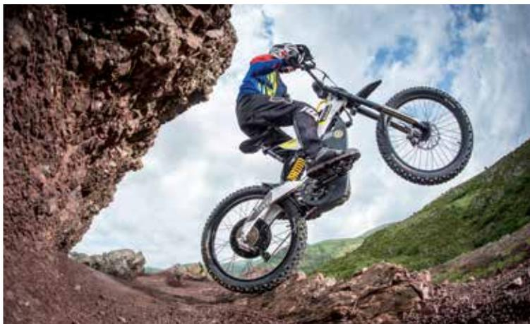
Il **Bultaco Brinco** è un mix tra moto da cross e bicicletta elettrica a pedalata assistita e dispone di motore elettrico incorporato nella ruota posteriore in grado di erogare **2 kw di potenza** e 60 nm di coppia che, abbinato ad un cambio a 9 velocità (18 in overdrive) controllabile attraverso un pulsante situato sull'asta dei pedali, è in grado di spingere il mezzo fino a raggiungere una **velocità massima di 60 km/h**.
