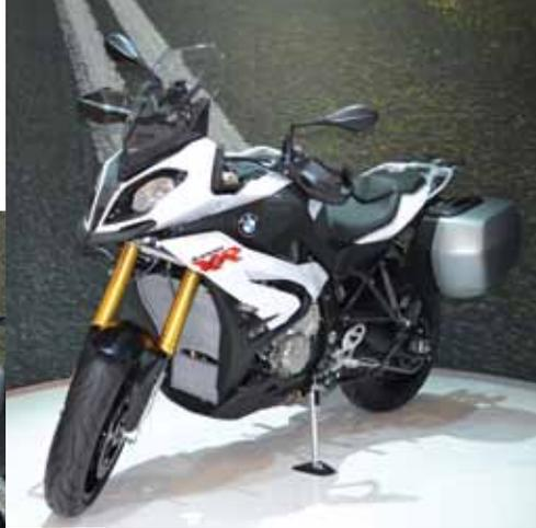
из алюминия и двигателем в качестве несущего элемента. На передней части вилка 46 мм, а на задней - регулируемый главный амортизатор или электронное дополнительное регулирование.
