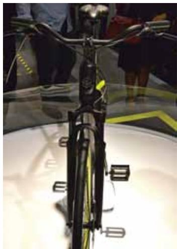
Il telaio in alluminio declinabile in più versioni, ha al suo interno il gruppo powertrain: un motore da 250W-350W, disegnato intorno all'asse pedale in ombra alla corona, e una batteria 400 Wh agli ioni di litio, alloggiata sotto la sella, facilmente estraibile.
