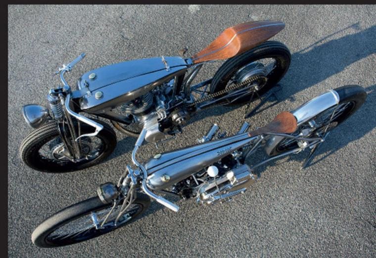
corredato da un impianto a doppia camma con catene di bronzo. Sulla moto spiccano il freno a tamburo della ruota anteriore e le manopole metalliche del manubrio con i componenti argentei di telaio e motore a contrasto con la patina rassicia sul serbatoio e le tonalità marroni della sella in
