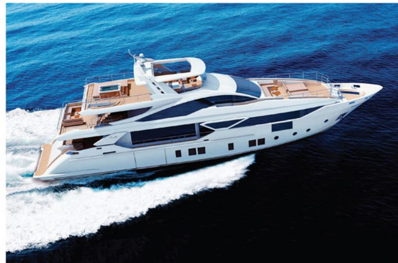
Il sistema propulsivo è composto da una coppia di Azipulls Rolls-Royce AZP65C, in grado di sviluppare oltre 2600 CV di potenza ciascuno e caratterizzati da eliche traenti azipodali, manovrabili con un semplice joystick posto in plancia.
