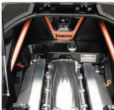
Realizzata con un telaio in tubolari di acciaio, la vettura ha una struttura portante in nido d'ape d'alluminio, mentre la carrozzeria è in fibra di carbonio, per consentire un peso di soli 1.390 Kg, con una distribuzione di pesi bilanciata al 45% all'anteriore e al 55% al posteriore.
