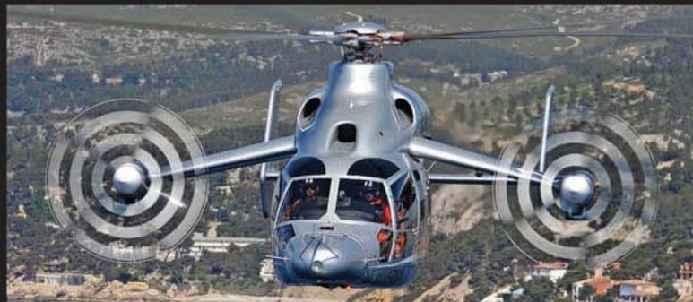
современных вертолетов, и входящей в крупнейшую европейскую корпорацию аэрокосмической промышленности EADS. Демонстратор X3 обладает перспективной винтокрылой транспортной системой, имеющей скорость турбовинтового самолета и взлетно-посадочные характеристики вертолета, создающей низкие уровни вибрации, что исключает необходимость применения пассивных или активных антивибрационных систем. Силовая установка Rolls-Royce Turbomeca RTM322 состоит из основного несущего винта
