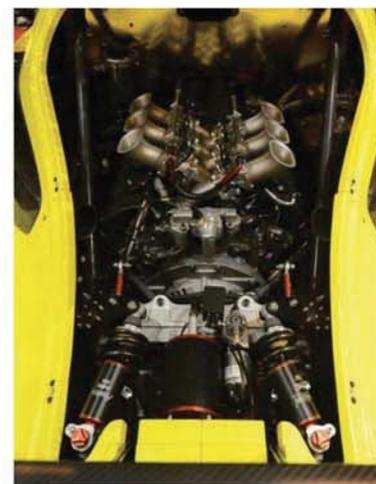
Il corpo auto è da auto estrema, con un abitacolo stile corsa, pensato per guidatori ai quali non interessa il confort ma solo il piacere della guida. La vettura è spinta da un propulsore Ford V6 da 3,7 litri, abbinato ad un cambio a sette marce al volante, in grado di erogare 380 CV, potenza che consente alla vettura di raggiungere una velocità massima di 281 km/h.
