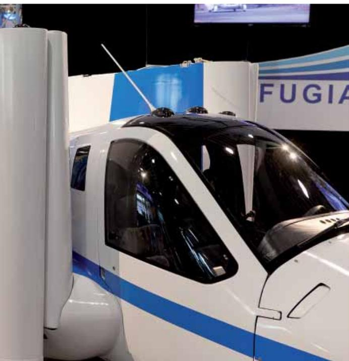
Spinta da un motore Rotax che eroga la potenza di 100 CV, in volo la Transition ha un'autonomia di circa 740 km grazie a un serbatoio di circa 90 litri ed è in grado di raggiungere una velocità massima di 185 Km/h e, grazie alla cabina pressurizzata, i 9.000 metri di altitudine.
