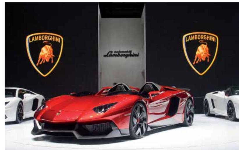
La parte frontale della Lamborghini Aventador J vede nel frontale dominare il voluminoso spoiler anteriore in fibra di carbonio a vista, dotato di braccetti di supporto centrali e di "winglets" laterali simili a quello di una monoposto di Formula 1.
