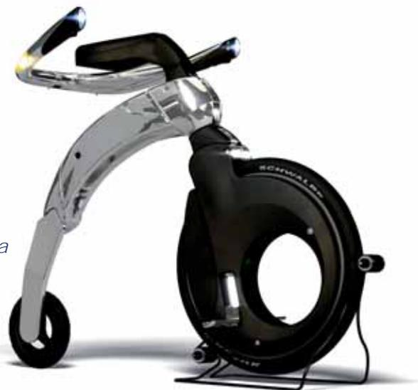
La YikeBike è una scultura in carbonio degna del MOMA in grado di chiudersi ed aprirsi in 15 secondi diventando grande quanto una sacca da palestra per un peso complessivo di 10 kg nel modello Carbon e di 14 kg nel modello Fusion. In questo modo risulterà possibile muoversi senza avere l'ansia di trovare un parcheggio, e lo si farà con un veicolo unico, innovativo nel suo genere e anche trendy nel design.
